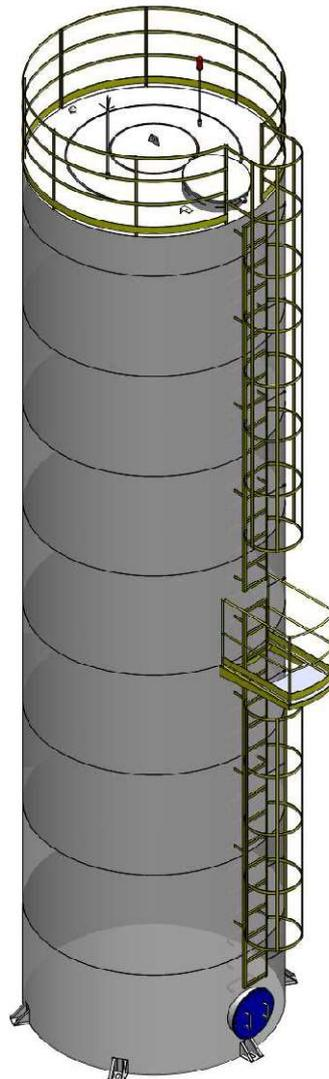
Figura 2 – MODELO RESERVATÓRIO METÁLICO TUBULAR 100 M3
